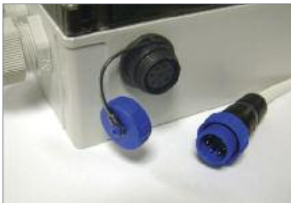
安装在装置外壳的防水接头（达到 IP67），而非 RJ11 端口内部。
