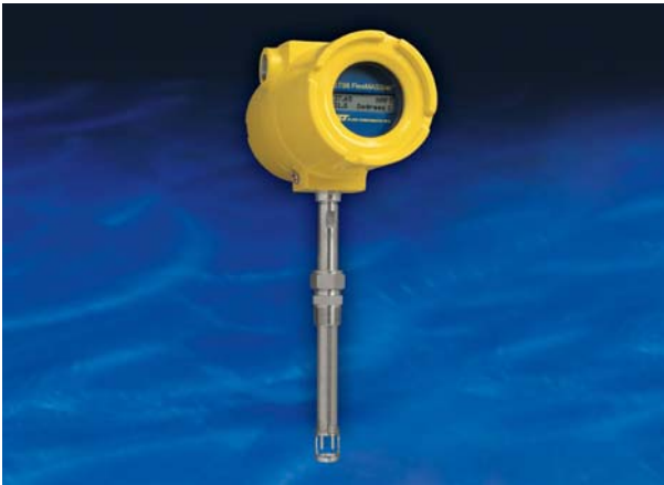
ST98 型 插入式流量计，适用于 2.5~42" [64~1066mm]的管径。典型标定范围为 0.75~600 SFPS [0.21~172 NMPS] 1
