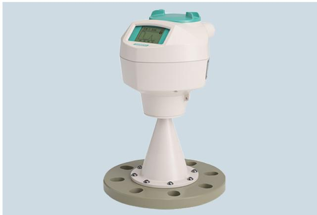
SITRANS LR250 PP 平面天线是两线制 25 GHz 脉冲雷达液位变送器，用于连续测量储罐和过程罐中液体，包括腐蚀性液体和浆料液位，量程 20 米。
